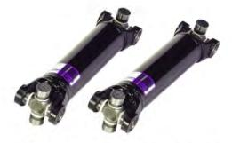
39800-VETT AXLE DRIVE SHAFT 4130 TUBE AND END FITTINGS SPICER JOINTS
